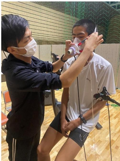
呼吸ガス分析装置を使って心肺機能を測定する
