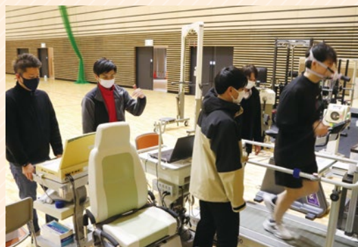
呼気ガス分析装置と慣性計測装置を用いてランニング動作を分析する院生たち
